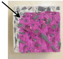
**Fig. 10** 2D chloride ion diffusion profile
