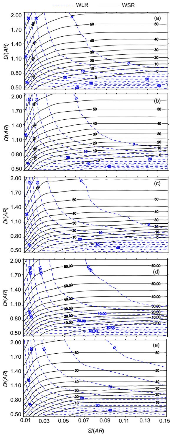
**Fig. 7** Calculation charts for designing store capacity of rainwater harvesting system. (a)  $r_G=60\%$ ; (b)  $r_G=70\%$ ; (c)  $r_G=80\%$ ; (d)  $r_G=90\%$ ; (e)  $r_G=100\%$
